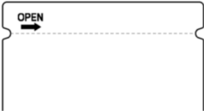
图 B.4 U形凹槽提示开口位置
